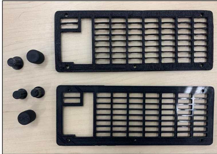
Figura 4: Peças de aeronave impressas em 3D para uso em simuladores de voo do CIAvEx.
