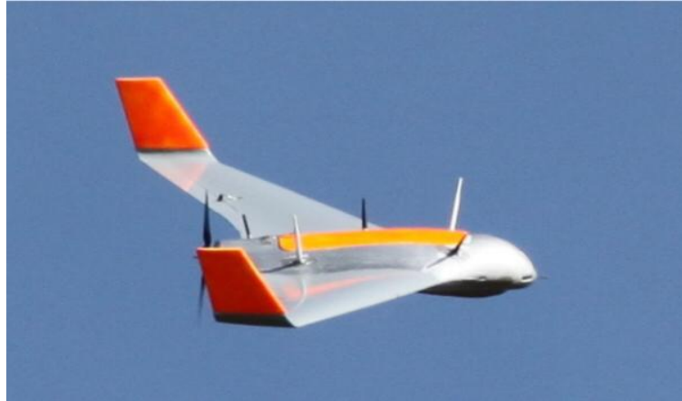
Figura 16 — Emprego do SARP ARP X8 com retransmissor de comunicações Fonte: Globecom 2014 Workshop - Wireless Networking and Control for Unmanned Autonomous Vehicles.)
