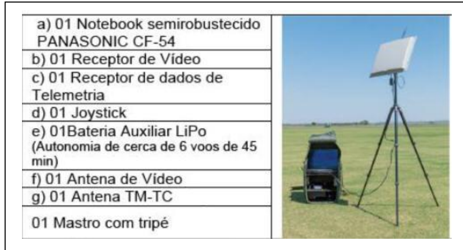
Figura 13 — Características técnicas da estação solo do SARP Horus FT-100 Fonte: RPAS FT 100
