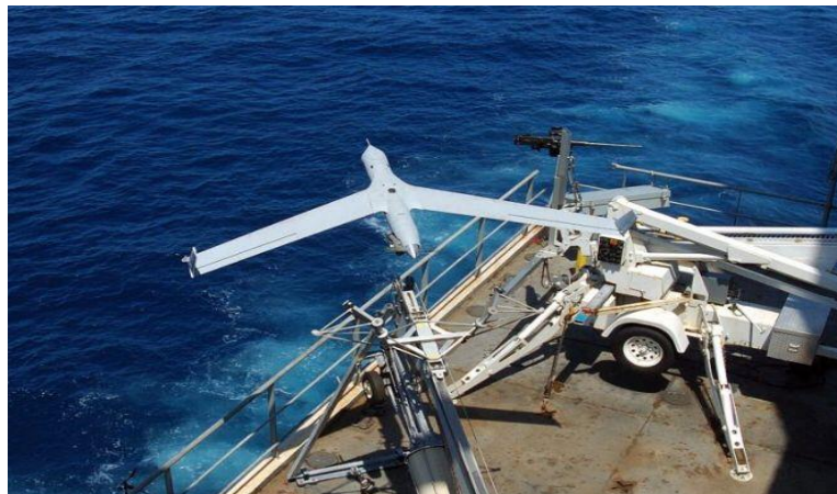
Figura 8 — SARP Scan Eagle em lançamento por catapulta Fonte: Naval Technology.
