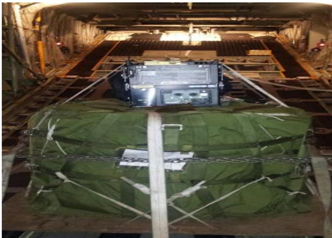
FIGURA 3: Sistema de lançamento SHERPA montado sobre uma carga
