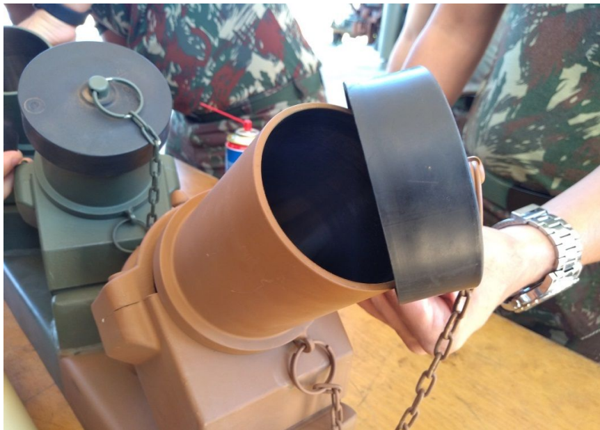
Imagem 4 – Tampa de borracha dos tubos lançadores de granadas fumígenas
