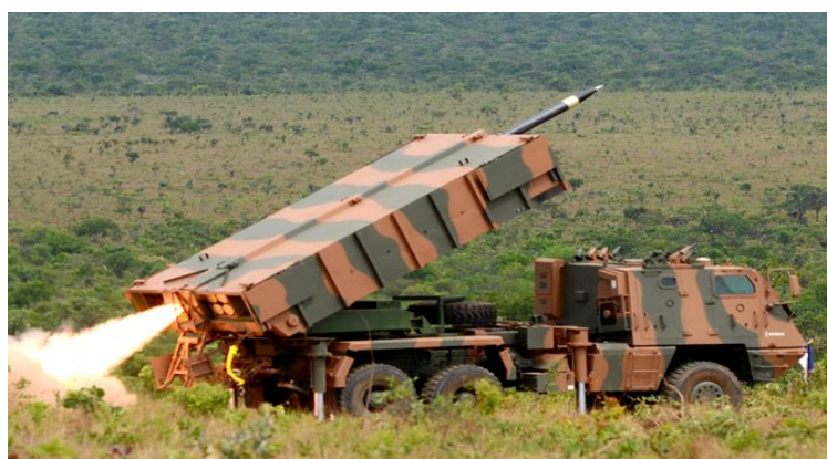
Figura 2: Plataforma versão MK-6 lançando um foguete SS-40
