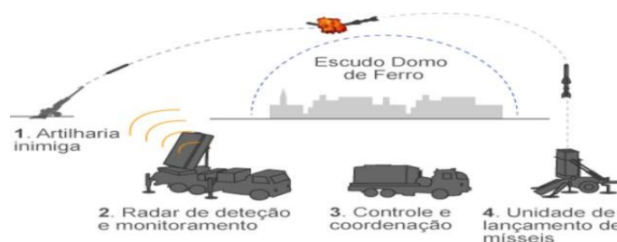
Figura 29: Funcionamento do Sistema Iron Dome
