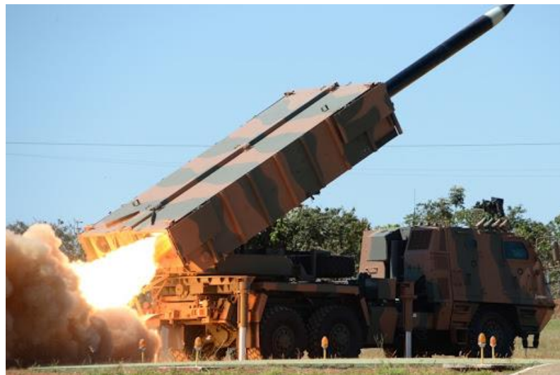
Figura 1 - Viatura LMU do Sistema Astros II Fonte: Forte jor
