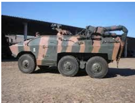
FIGURA 14 – Viatura Blindada de Transporte de Pessoal – média sobre rodas (VBTP – MSR) – Viatura Socorro - Guarani.
