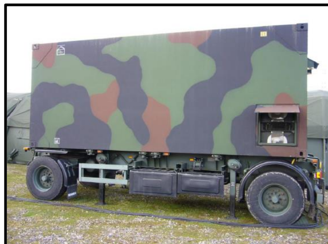
FIGURA 26: Servidor embarcado de redes de computadores para até 150 clientes. Fonte: ALEMANHA (2009).
