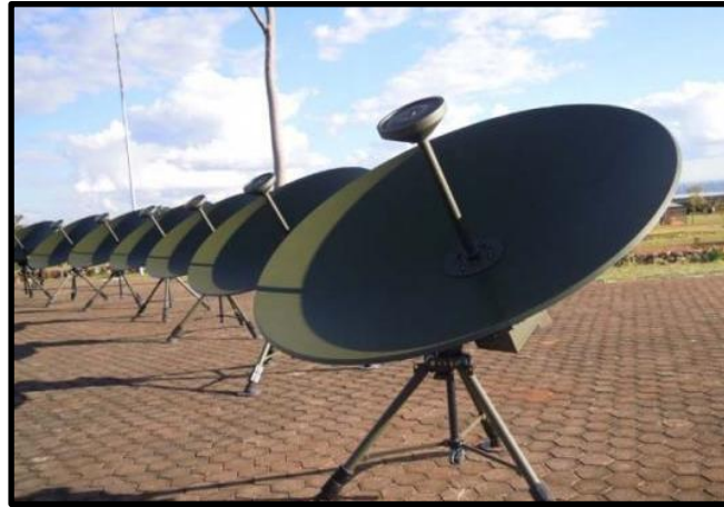
FIGURA 05 – Terminal Transportável do SISCOMIS Fonte: DEFESANET (2012).
