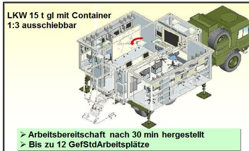
FIGURA 27: PC embarcado sobre Vtr 15 Ton para até 12 CPU. Fonte: ALEMANHA (2009).
