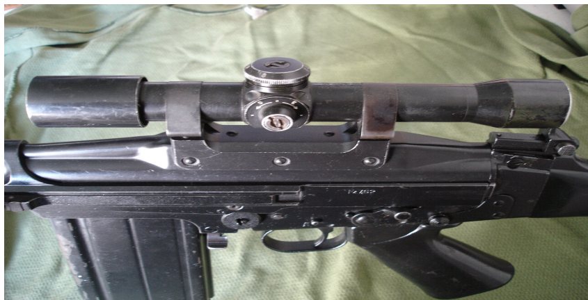
Figura 8 – Luneta OIP 3,6 montada na tampa da caixa da culatra do FAL
