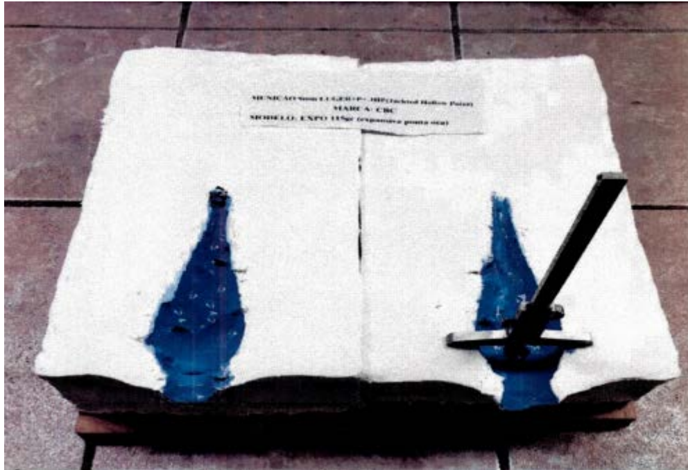
Figura 12 - Cavidade causada no disparo de 9mm Luger
