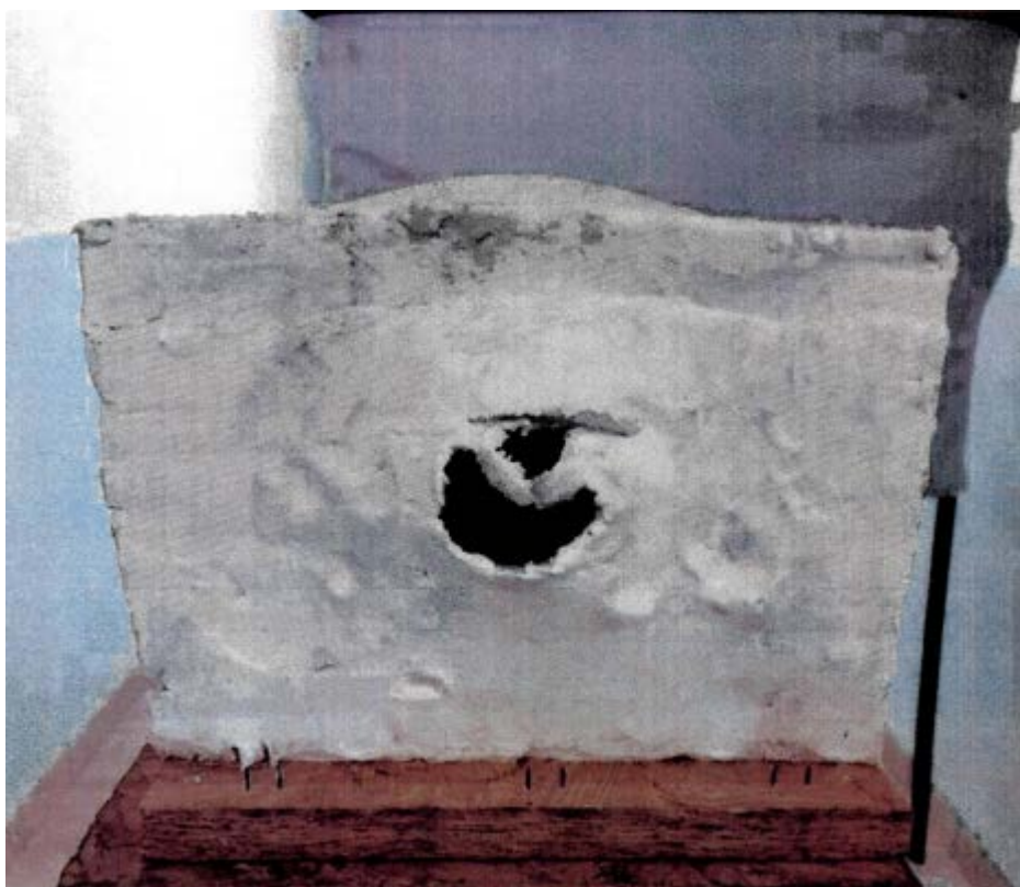
Figura 9 - Orifício de entrada de um disparo de .40 S&W
