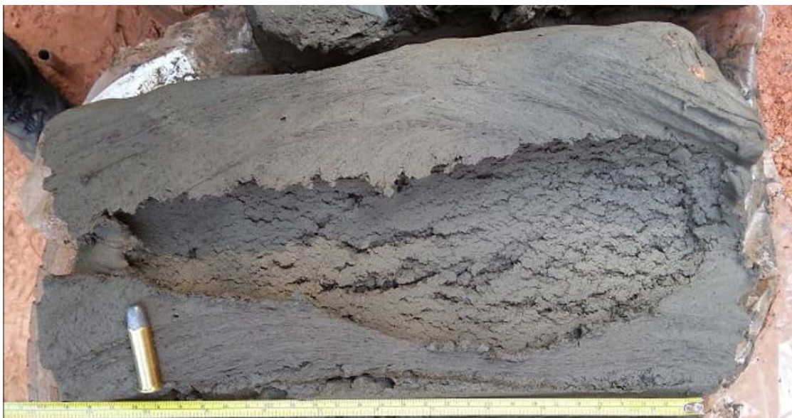
Figura 6 - Cavidade gerada por um disparo de .32 em concreto úmido
