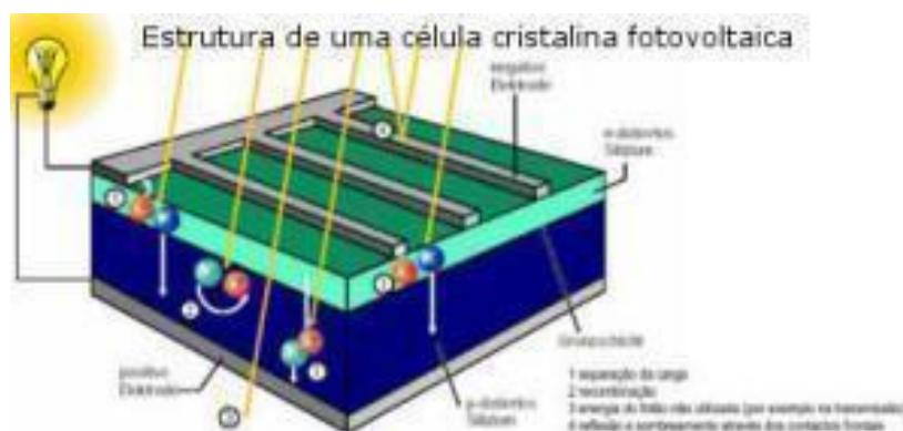
Figura 3 – Estrutura de uma célula cristalina fotovoltaica Fonte: disponível em https://www.apolar.com.br/blog/?p=4787
