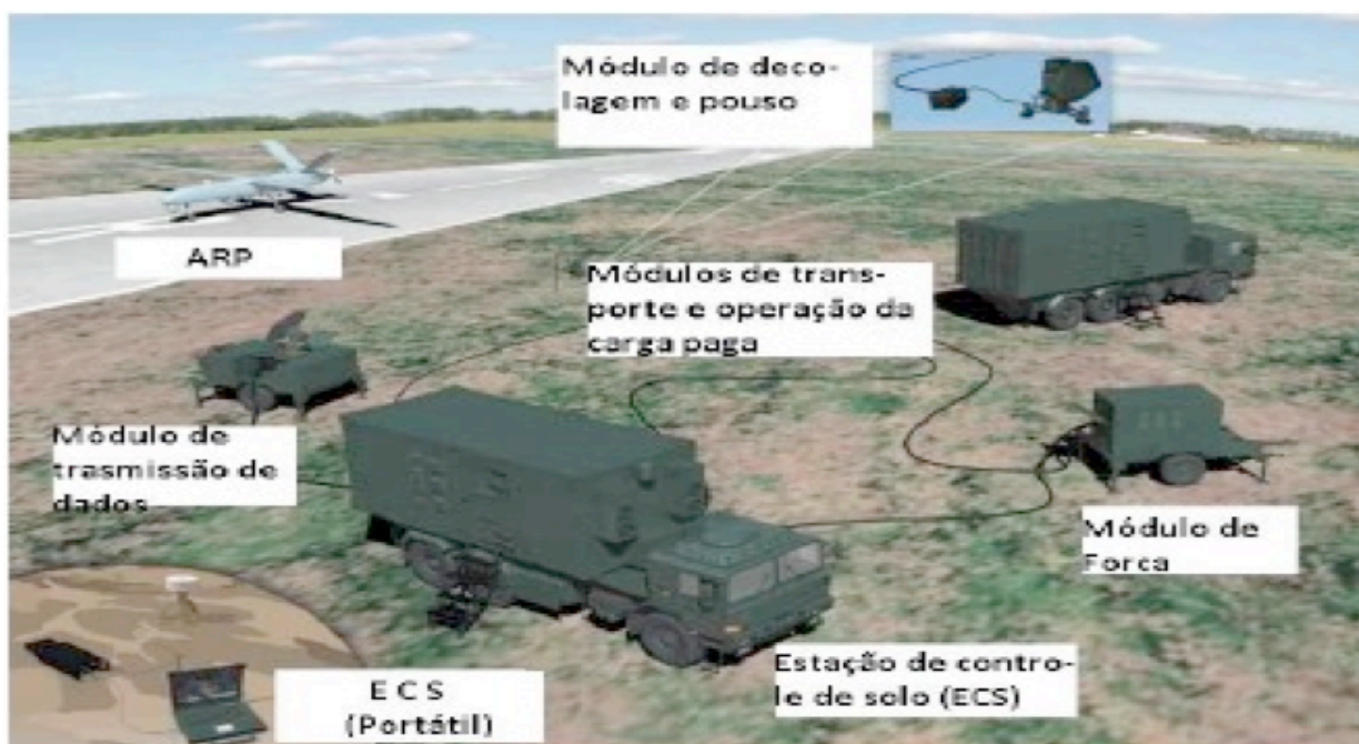
Figura 5 – Maquete ilustrativa dos subsistemas do SARP. Fonte: NOGUEIRA, Marcelo de Souza. O uso de Veículos Aéreos não Tripulados no Sistema Tático de Guerra Eletrônica . Brasília: Centro de Instrução de Guerra Eletrônica (CIGE).
