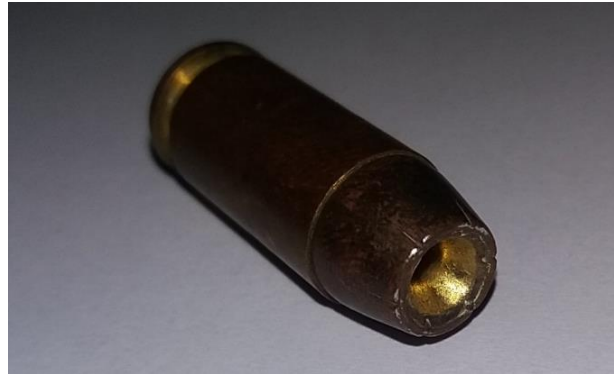
Figura 4 – Cartucho .40 SW fabricante CBC expansivo ponta oca nome comercial GOLD, observa-se detalhe do orifício do projétil (Foto: ARBEX, 2019).
