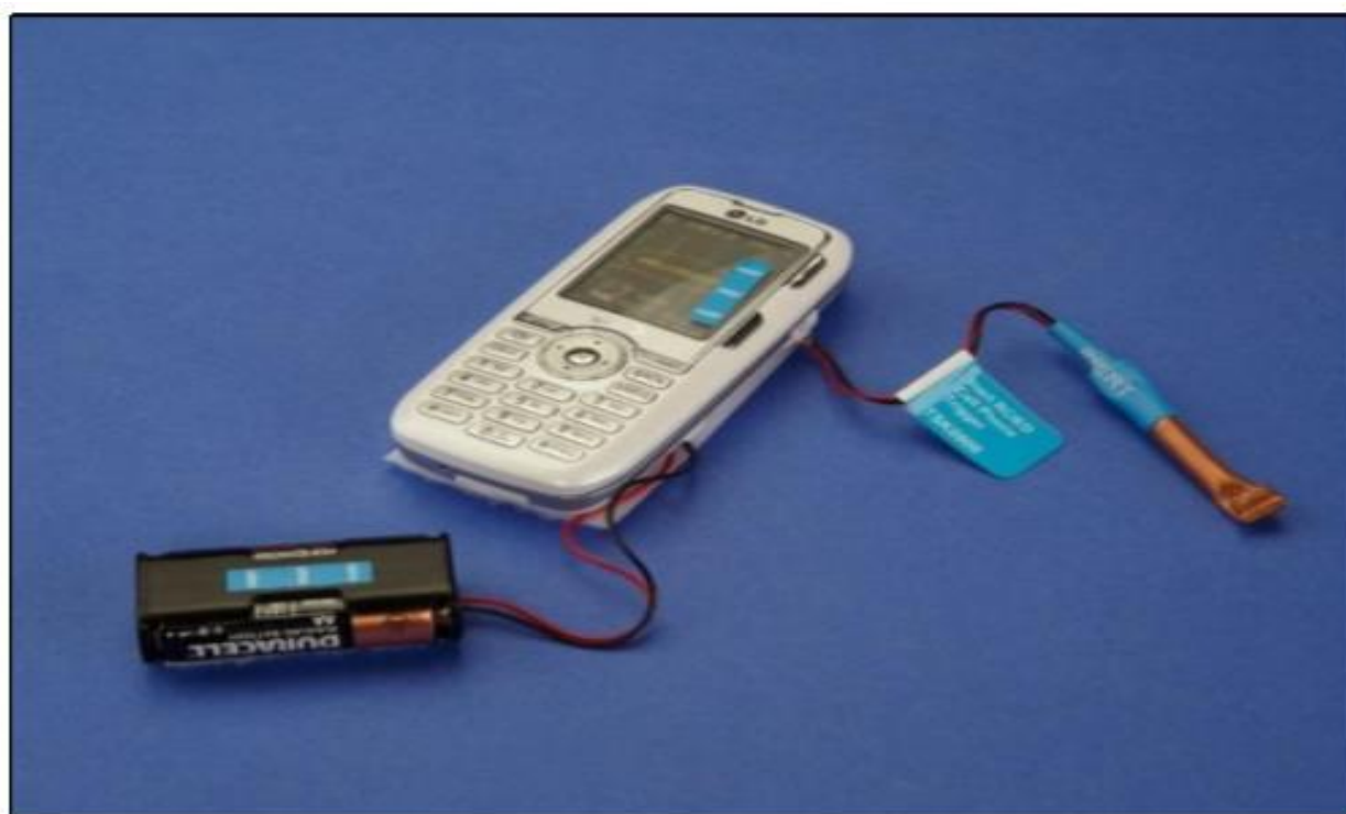
Telefone celular disparador de RCIED. FONTE: DSA DETECTION, S.d
