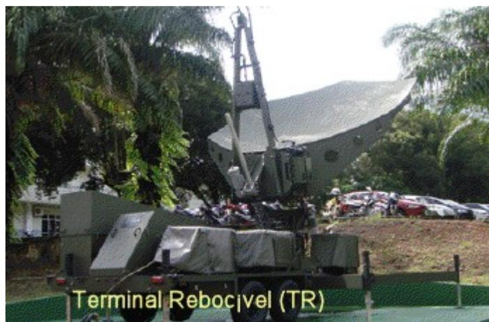
Figura 5. Estação de Transmissão Rebocável (TR)
