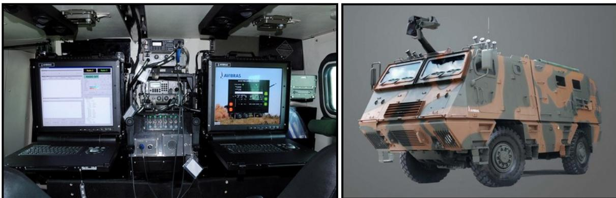
Figura 2. AV-VCC e AV-PCC (Viatura de Comando e Controle – Grupo e Viatura Posto de Comando e Controle – Bateria): Viatura capaz de: gerir o controle dos comboios durante deslocamentos via GPS, realizar e transmitir os cálculos de tiro através de meio eletrónico e tem capacidade de trabalhar como Centro de Comando e Controle.
