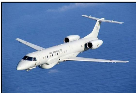
Figura 4. Aeronave EMBRAER R-99 realiza o sensoriamento remoto, capaz de captar imagens cartográficas em altíssima resolução, a grande altitude.
