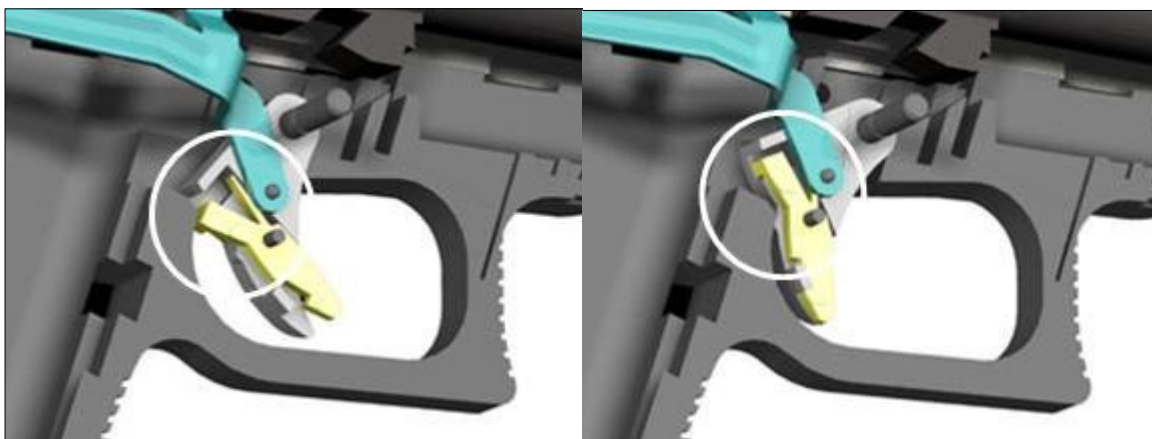
Figura 10 – Pistola Glock 19 (Dispositivo de Segurança do Gatilho)
