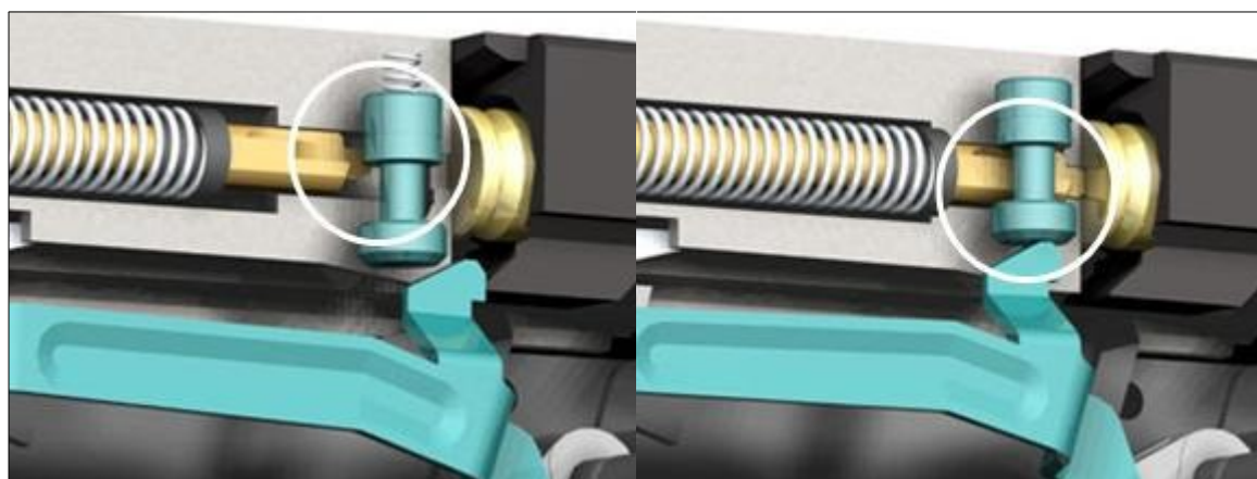
Figura 11 – Pistola Glock 19 (Dispositivo de Segurança do Percussor)
