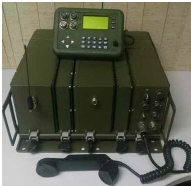
Figura 3- Protótipo do RDS-Defesa versão veicular Fonte: CTEEx
