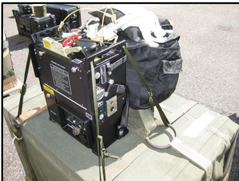
FIGURA 3 – Sherpa PADS - Ranger 700 - instalado em uma carga de suprimento
