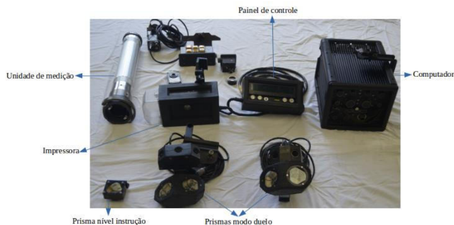
Figura 5 - Equipamento DSET BT- 41 utilizado na instrução das guarnições blindadas Fonte: Centro de Instrução de Blindados, 2023.
