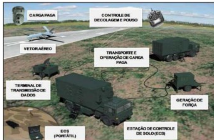
Figura 1: Composição de um SARP Fonte: Brasil, 2020a, p. 4-5
