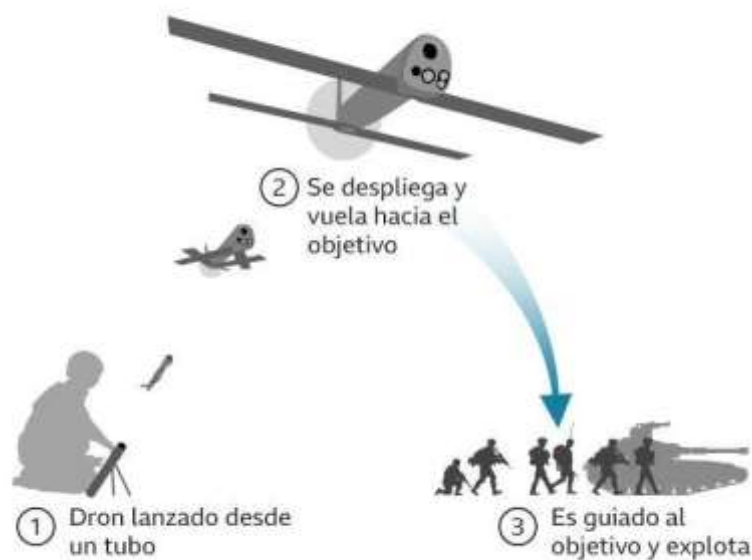
Figura 8 – Funcionamento do drone Switchblade
