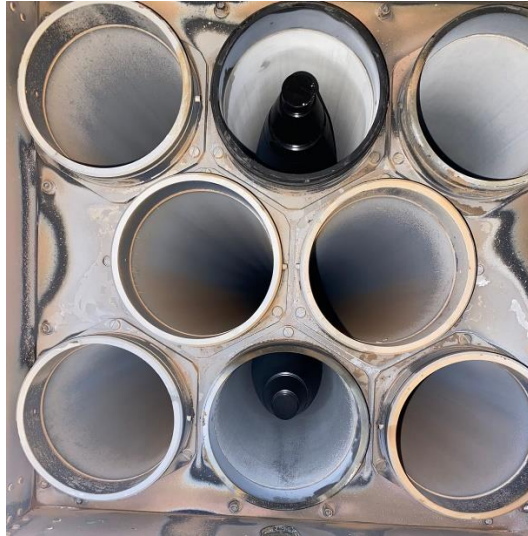
Figura 4: Foguetes SS-30 deslocados dentro do tubo lançador do CL
