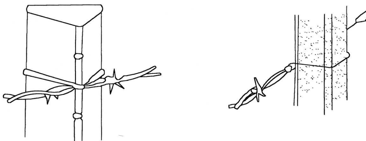
Figura 3 – Amarração dos fios nos postes (braçadeiras de arame liso)
