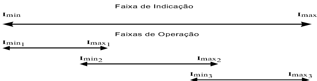
Figura 2 – Faixas de Indicação e Operação Fonte: Departamento de Engenharia Mecânica da UnB
